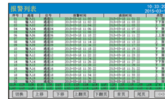
报警列表：显示最近的通道报警时间、消报时间及报警状态等信息
