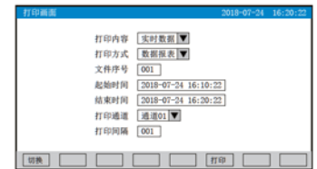
打印画面：可打印实时数据和历史数据，通过设定起始时间和结束时间来打印历史曲线和数据
