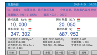
流量画面：将流量回路里的流量、温度、压力信息以组合的方式显示在同一画面上，同时显示各参数信息
