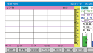
实时控制：可实时显示与控制相关的曲线和参数
