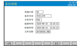
备份画面：可通过设定起始时间和结束时间来备份这段时间的数据
