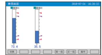
棒图画面：以棒图的形式显示测量值，同时还可显示通道位号、工程单位及报警状态等信息
