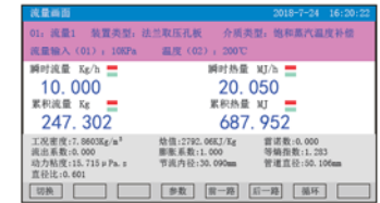
流量画面：将流量回路里的流量、温度、压力信息以组合的方式显示在同一画面上，同时显示各参数信息
