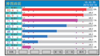
棒图画面：以棒图的形式显示测量值，同时还可显示通道位号、工程单位及报警状态等信息
