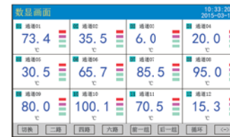
数显画面：显示实时测量值，同时还可显示通道位号、工程单位及报警状态等信息
