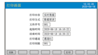
打印画面：可通过设定起始时间和结束时间来打印这段时间的曲线和数据
